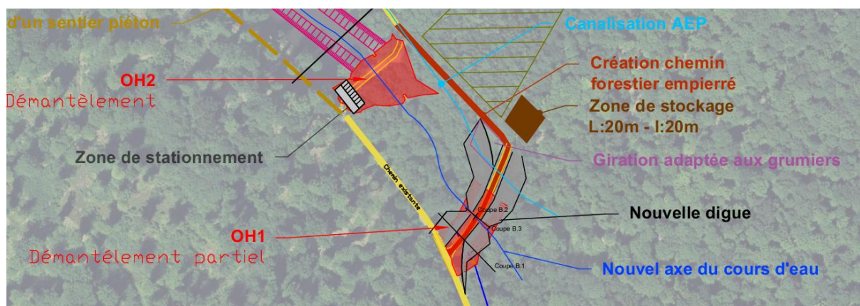
Fig. 14. Zoom sur l'ouvrage OH1
